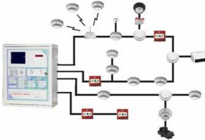
Rys.2. Schemat ideowy Systemu sygnalizacji pożaru.
